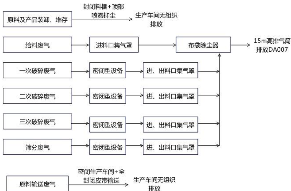
图 4-1 废气收集治理排放示意图
