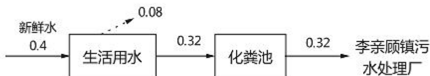
图 2-1 项目水平衡图 单位: \text{m}^3/\text{d}
