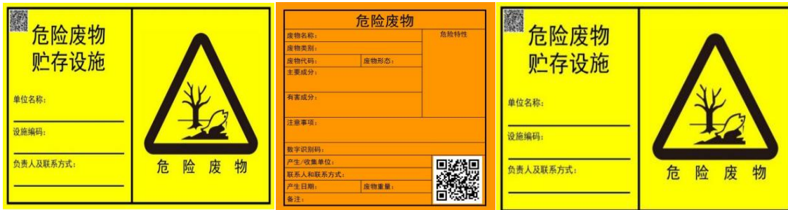
危险废物贮存分区标志
