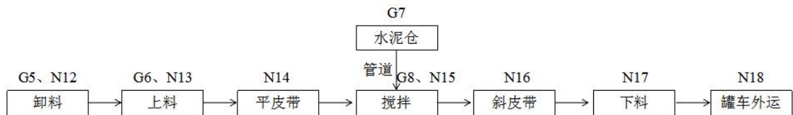
图 2-5 水泥稳定碎石生产工艺流程图
