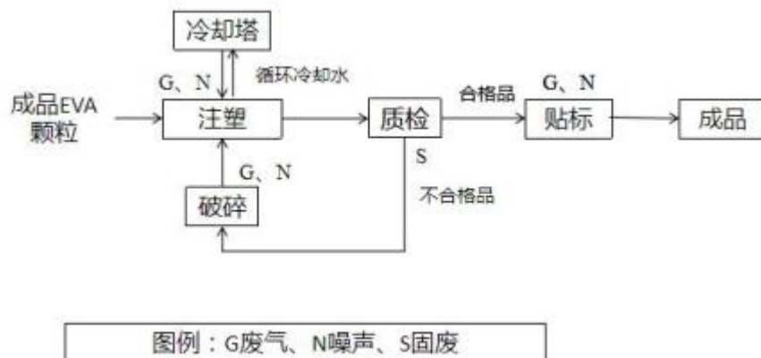
图 2-4 EVA 拖鞋生产工艺流程及产排污节点图
