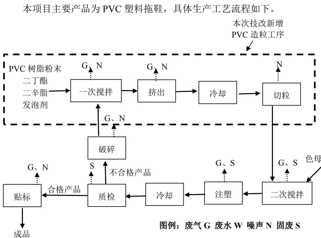
图 3 PVC 拖鞋生产工艺流程及污节点排图
