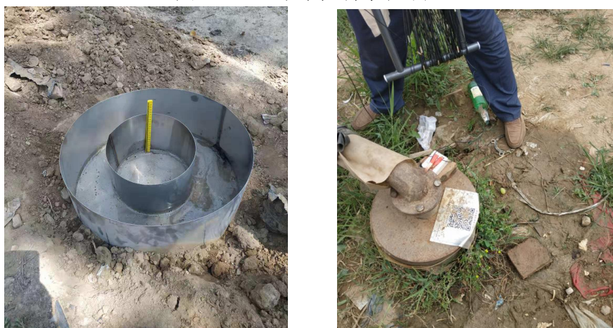
图 6.3-2 野外渗水试验、抽水试验
