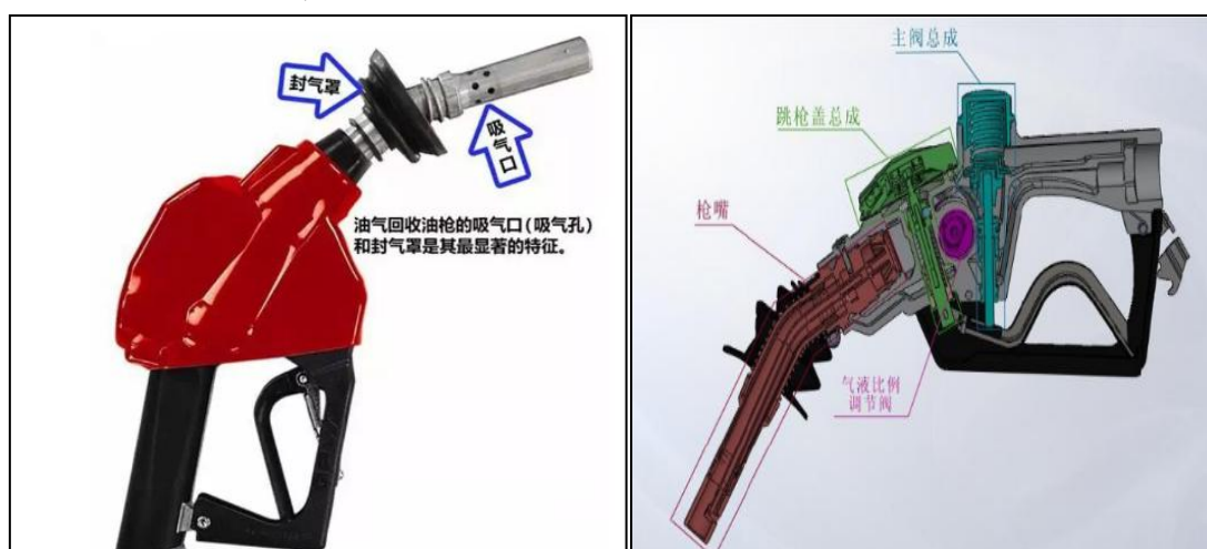
图6 油气回收枪示意图
