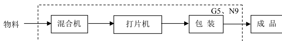
图3 OC 型消毒剂（二氧化氯）生产工艺流程图
