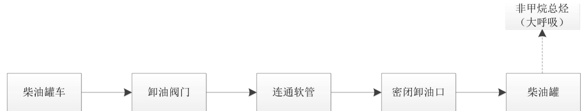
图 1 柴油卸油工艺流程及产污节点图
