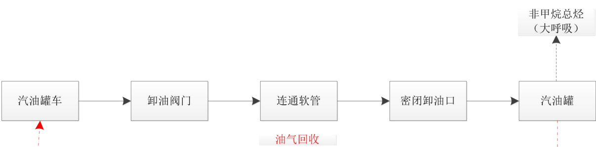
图 3 汽油卸油工艺流程及产污节点图
