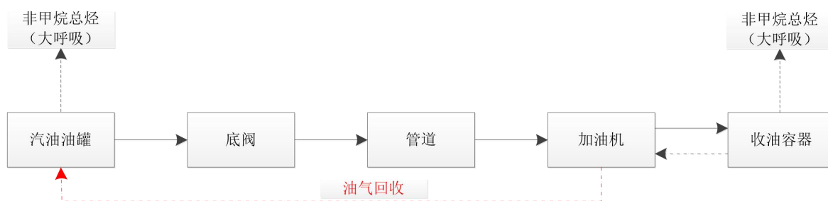
图6 汽油加油工艺流程及产污节点图
