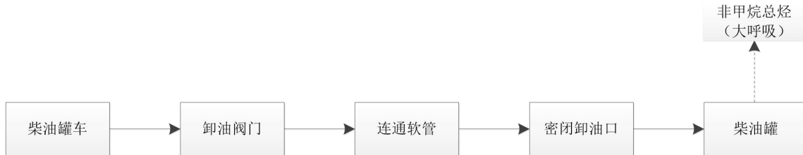
图3 柴油卸油工艺流程及产污节点图
