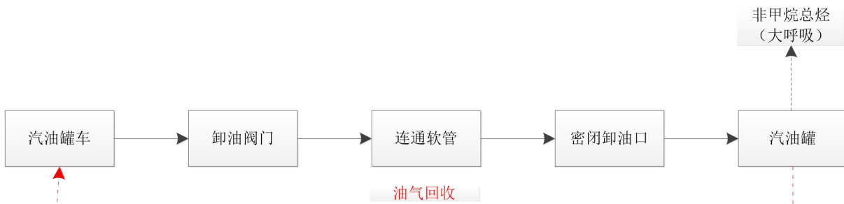
图5 汽油卸油工艺流程及产污节点图
