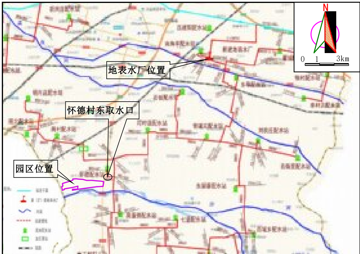
图6-1-8 地表水厂输配水管网图
