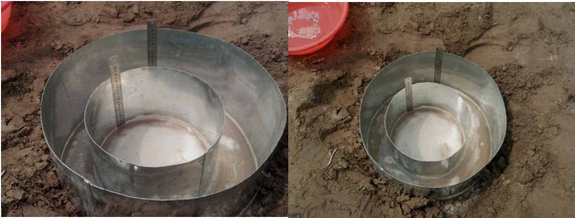
图 5-10 双环渗水试验照片
